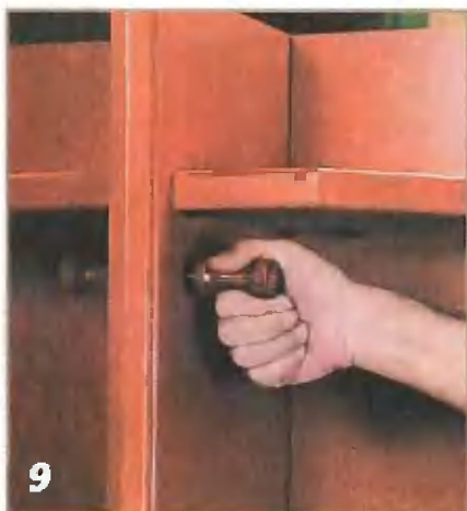
9 Деревянные крючки для одежды устанавливают на буковых шкантах Ø 8 мм.
