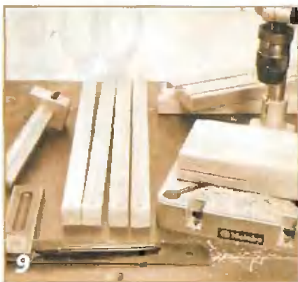
9 В брусках рамы сверлят отверстия под шурупы. Сверлом большего диаметра отверстия рассверливают под головки шурупов.
