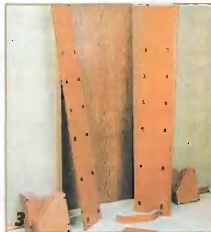
Заранее просверленные отверстия позволяют закрепить полочные доски на требуемой высоте.
