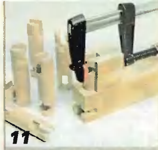
Шаблон для сверления и пиления опор.
