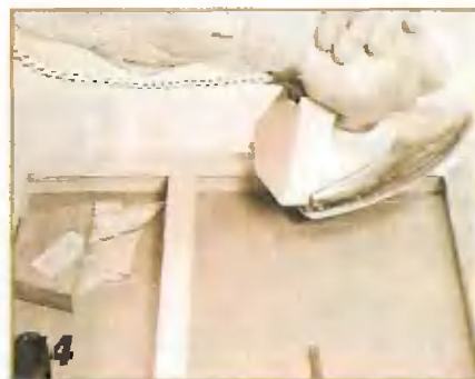
11 Подсохший клей под воздействием тепла и давления реактивируется.
