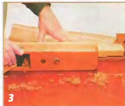
3 Стыкуемые края шпона можно зачистить с помощью ручного фуганка.
