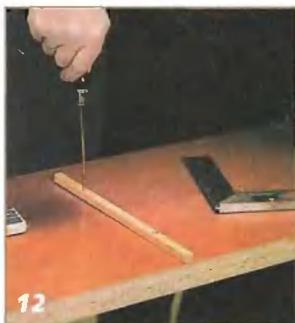
12 Посредством этой планки полку для головных уборов соединяют с центральной несущей стенкой вешалки.
