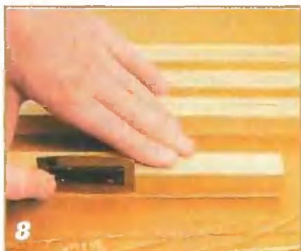
8 «Свесы» фанеровки осторожно удаляют мелкозубчатой пилой для резки шпона.
