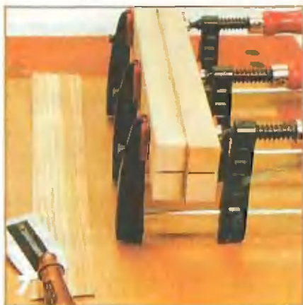
10 При фанеровании брусков рамы полосу шпона сначала приклеивают к их внутренней поверхности.
