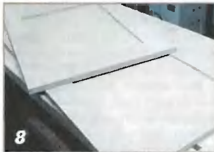
После высыхания клея слегка зачищают зоны стыков деталей рамы.
