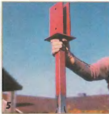
5 Анкеры изготавливают из стальной трубы сечением 50х50 мм и стального листа толщиной 5 мм. Соединяют детали сваркой.
