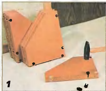
По углам готовых полок устанавливают мебельные стяжки.
