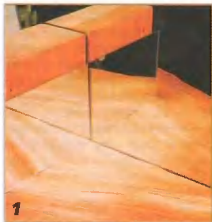
1 Трюк с двумя зеркалами помогает подобрать шпон по текстуре древесины.
