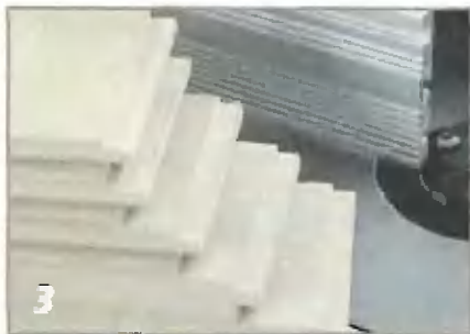
Шипы на торцах стоек рамы должны быть одинаковыми.
