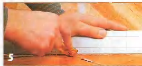
5 Выступающий шпон на торцах срезают с помощью ножа с круглым лезвием и линейки.
